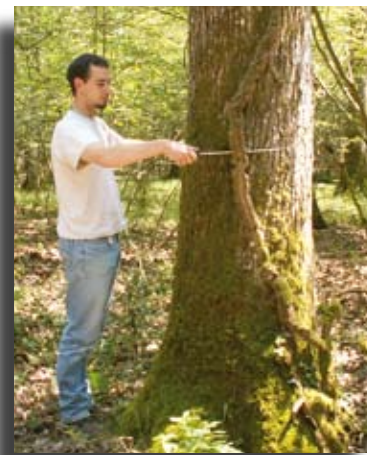
Au compas forestier, le diamètre se mesure à 1,30 m du sol
